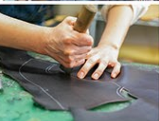
パーツごとに革を切る作業。革同士が重なる部分は革通き包丁を使って厚みを薄くするなど、見えな部分にも細かく手を加える
