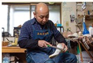
石こうを流して取った足型は、パテで盛ったり削ったりしながら実際の形を再現していく
