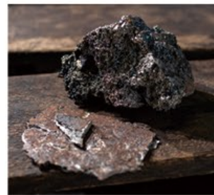
材料の玉鋼(奥)と、熱して板状にしたもの。この玉鋼は島根県で、日本古来の「たたら吹き」という製法で作られる
