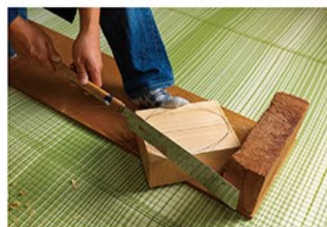
角材に鉛筆で下絵を描き、まずはのこぎりで四隅を切り落とす。この後は型紙で正面と側面からラインを確認しながら、面を削り出していく
