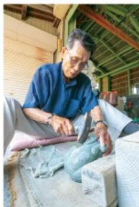
ツルと呼ばれる道具を使い、表面に細い筋を刻む。笏谷石ならではの繊細な技法
