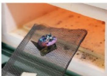
800℃の電気炉に入れて焼き付ける。2分ほどして釉薬が溶けたら窯から出す。直後は真っ黒だが、徐々に元の釉薬の色が浮かび上がってくる
